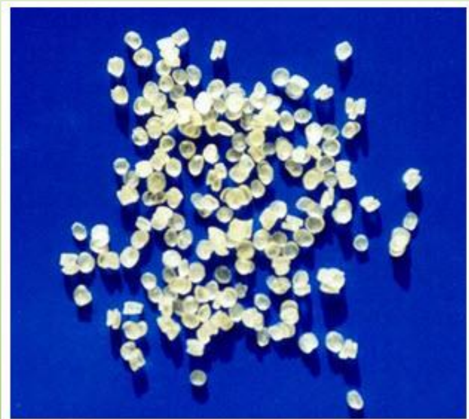
ภาพที่ 2 เม็ดพลาสติกที่ผลิตจากเทอร์โมพลาสติกสตาร์ช (thermoplastic starch หรือ TPS)
